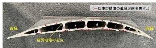
図3 16番ブレードの破面 破面は、主翼の破面と類似している。(写真出典:UTC資料)
