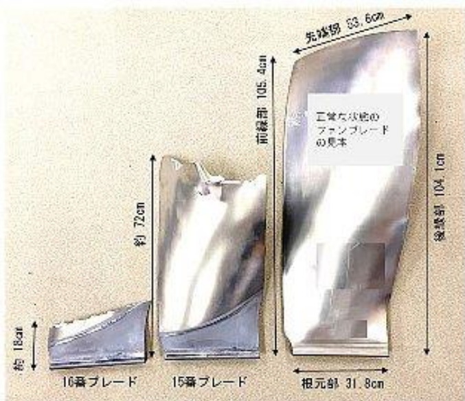
図2 ファンブレードの破損状況
