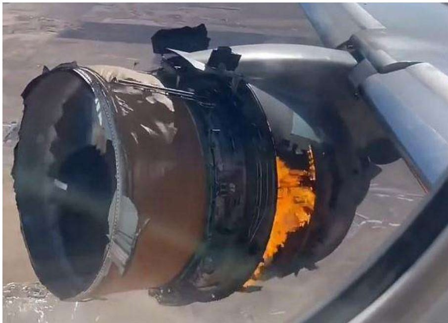
右エンジンのカウリング脱落、後部火災
