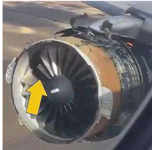
右エンジンのファンブレード飛散
